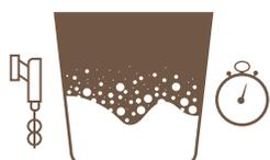
Empezar a agitar con un mezclador a no más de 600 rpm durante 2 minutos hasta obtener una masa homogénea.
