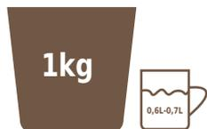
Verter previamente 0,6 litros de agua por 1 kilogramo de mezcla en un recipiente vacío, en función del tamaño/peso de la bolsa.
