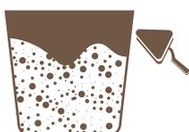
Para comprobar la calidad, tome una pequeña cantidad de la mezcla con el aparato y déle la vuelta. Si la masa se enciende/permanece en el aparato, la mezcla está lista.
